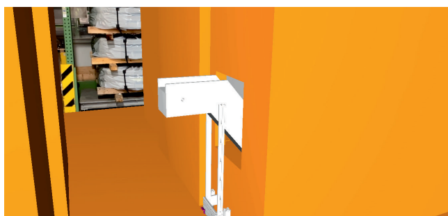
AR-Projektion einer Stanze mit Schallumhausung und Gutteil-auswurf. Im Hintergrund der virtuellen Stanze ist ein reales Lageregal mit Rohmaterial-Coils zusehen.
